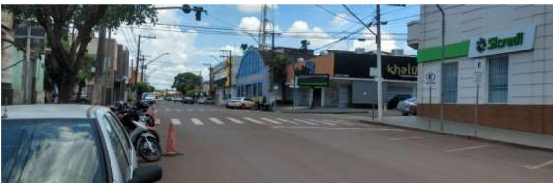
Figura 75 – Travessia de pedestres com apenas um lado contendo rampa de acessibilidade
